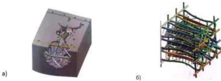
Рис. 4. Характер руйнування дослідної залізобетонної плити з комбінованим армуванням при високошвидкісному ударі: а — зона локального пошкодження; б — схема армування плити до взаємодії з ударником [4]
