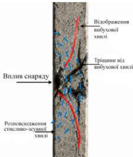
Рис. 1. Поширення стискальної та розтягальної хвиль у бетонному елементі при високошвидкісному ударному навантаженні [7]
