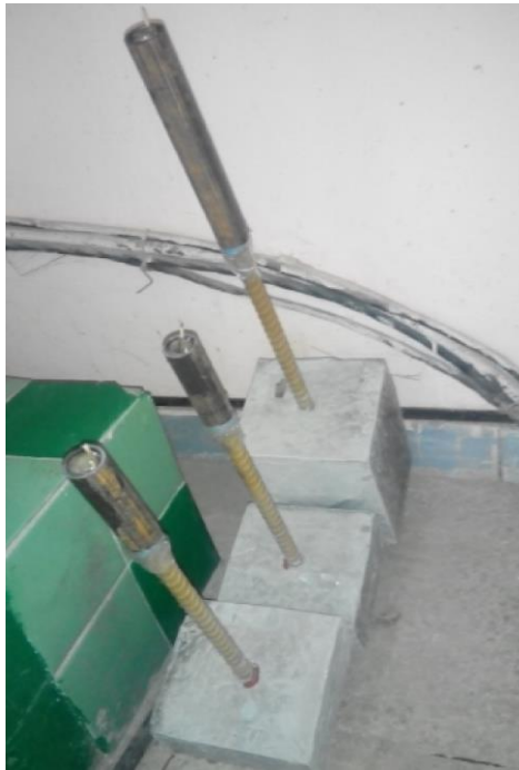
Рис. 1. Захист композитних арматурних стержнів від пошкодження в захваті розривної машини
