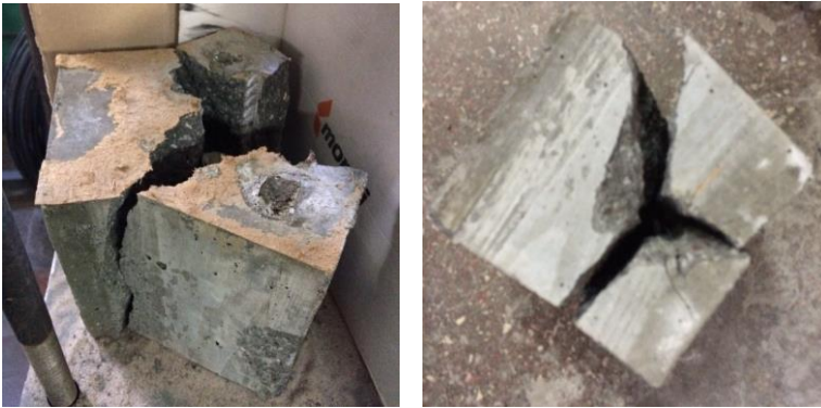
Рис. 5. Характер руйнування зразків з діаметром стержнів 16 мм
