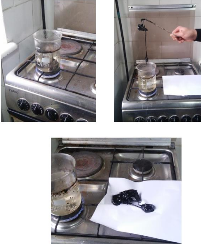
Рис. 2. Визначення зчеплюваності (адгезії)
