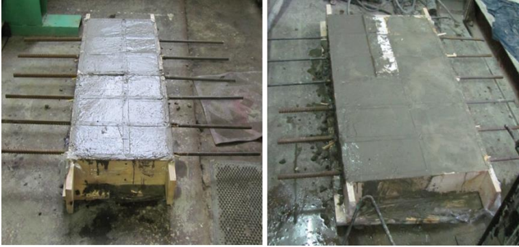
Рис. 2. Виготовлення основних зразків в касетних дерев'яних формах
