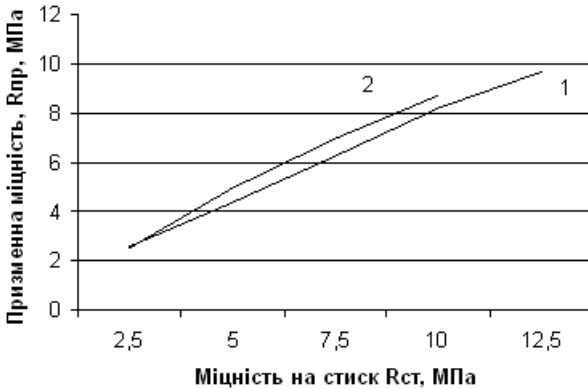
Рис. 3. Залежність бетонів між міцністю на стиск та призматичною міцністю: 1 – легкий керамзитобетон; 2 - легкий бетон на пористих заповнювачах - силуроактипоритах із техногенної сировини
