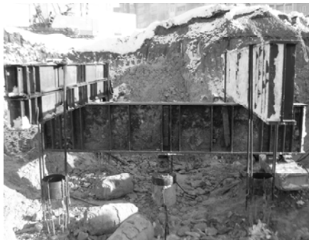
Рис. 4. Випробування несучої здатності палі статичними вдавлювальними навантаженнями: а) стенд для випробування несучої здатності палі; б) буроін'єкційна палія, що підлягає випробуванню
