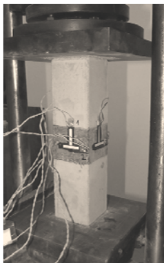
Рис. 1. Общий вид испытываемого образца при определении модуля упругости ( E_m ) и коэффициента Пуассона ( \nu_m ): а – во время испытания; б – после разрушения.
