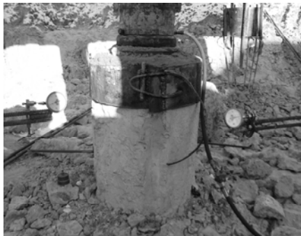
Рис. 4. Випробування несучої здатності палі статичними вдавлювальними навантаженнями: а) стенд для випробування несучої здатності палі; б) буроін'єкційна палія, що підлягає випробуванню
