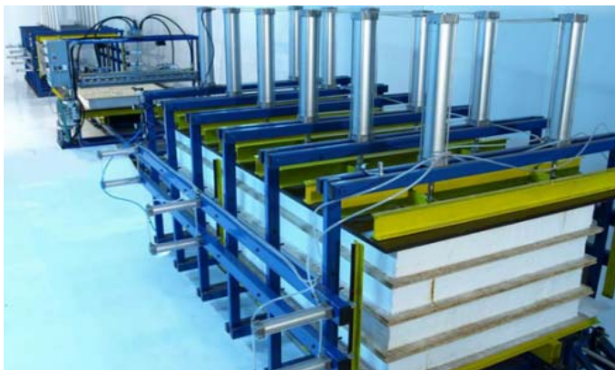
Рис. 2. Виготовлення SIP панелі
