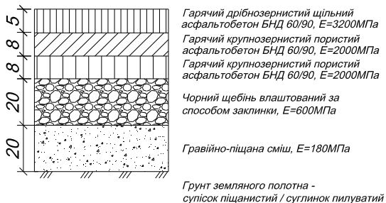
Рис. 1. Капітальний тип конструкції дорожнього одягу
