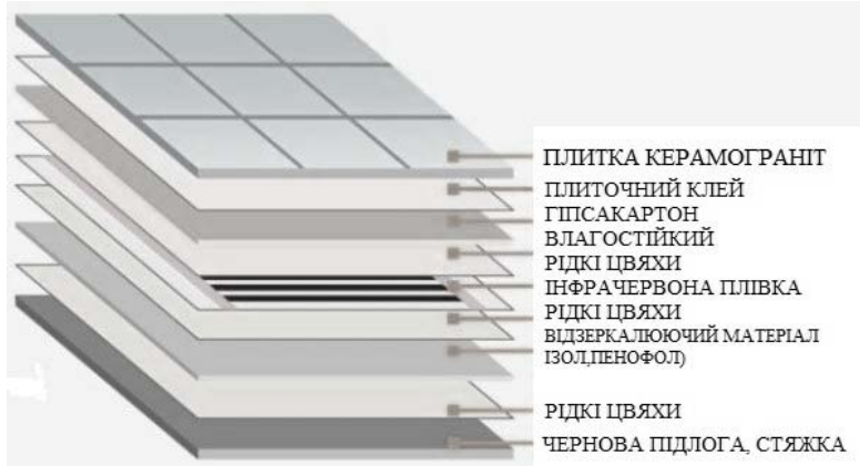
Рис. 5. Схема вкладання плівки під кахель
