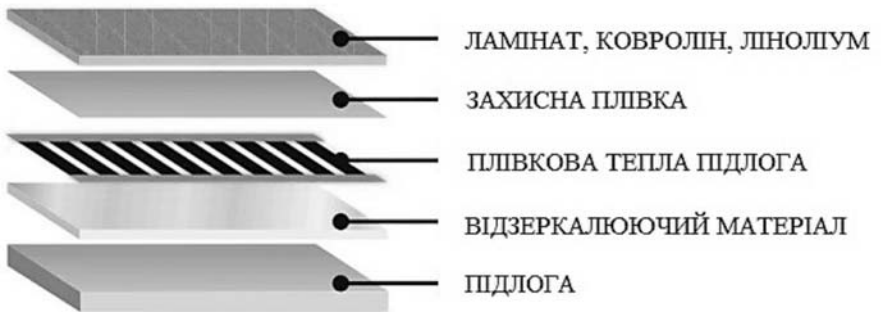
Рис. 4. Схема укладання плівки
