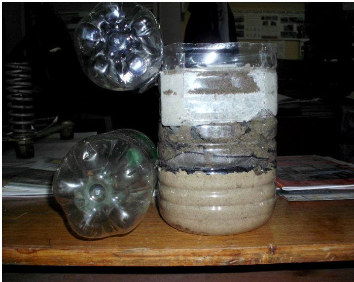
Рис. 4. Модель тротуарного покриття з профільованою мембраною
