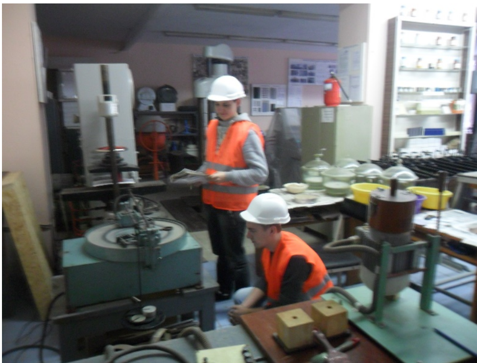
Рис. 1. Визначення стираності на приладі ЛКИ-3.
