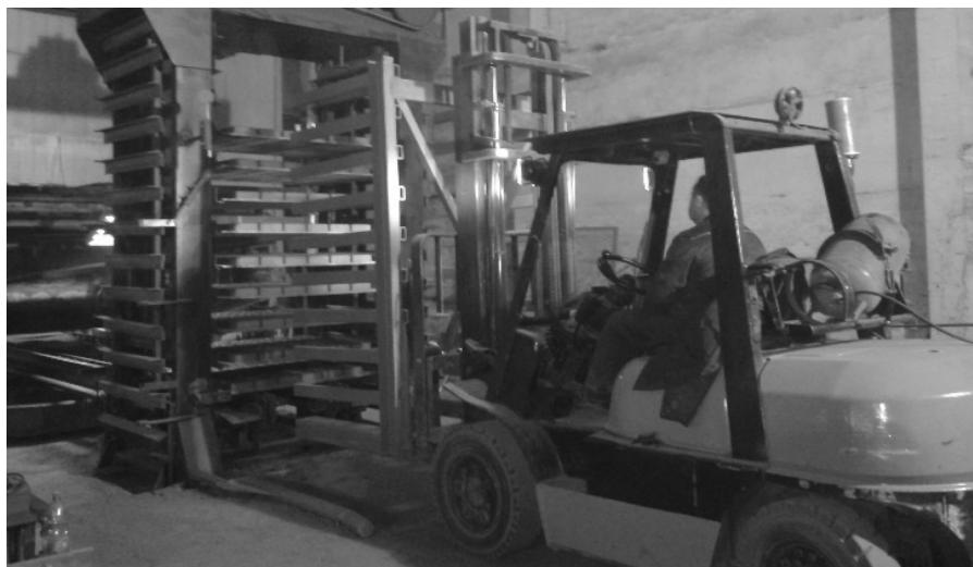
Рис. 4. Транспортування готової продукції у сушильну камеру.
