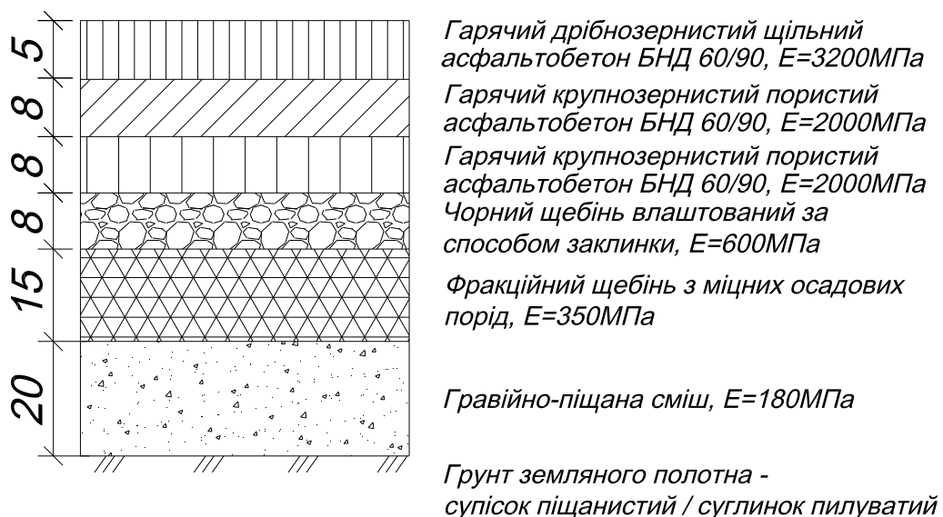
Рис. 1. Капітальний тип конструкції дорожнього одягу
