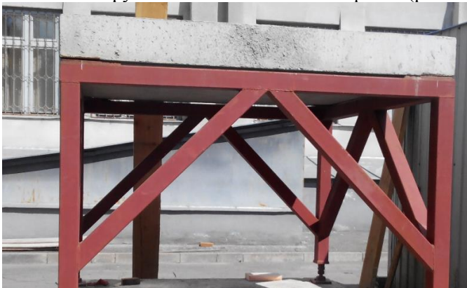
Рис. 6. Модель строительной конструкции системы «Монофант»
