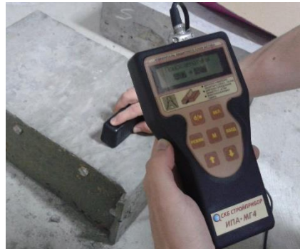
Рис. 3 Випробування дослідних зразків приладом ИПА-МГ4
