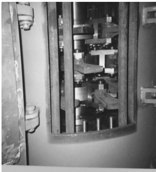
Рис. 2. Промышленная дробильная установка со снятыми стержнями решетки
