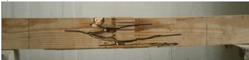
Рис.3.Характер руйнування дерев'яних балок: а) БД-1 ; б) БД-3 ; в) БД-5
