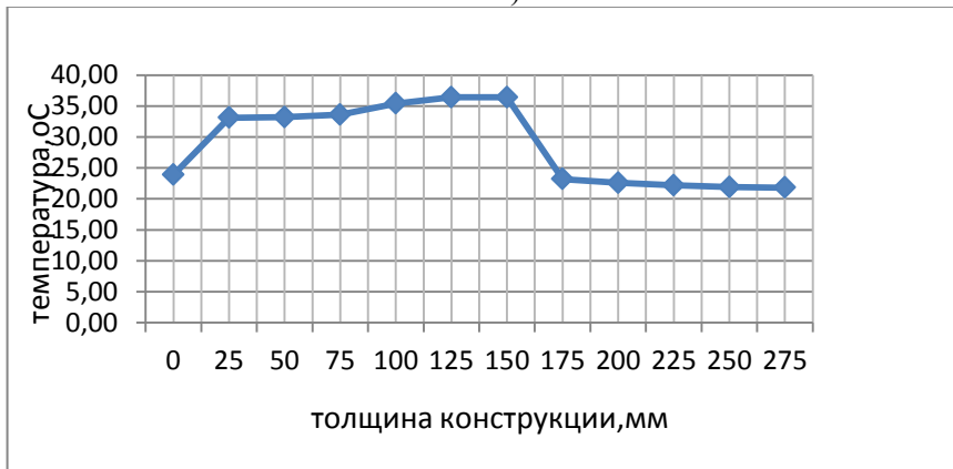
Рис. 11 - Распределение температур в ограждающей в конструкции при установившемся стационарном процессе
