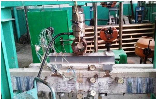
Рис.3. Загальний вигляд випробовування підсиленних балок
