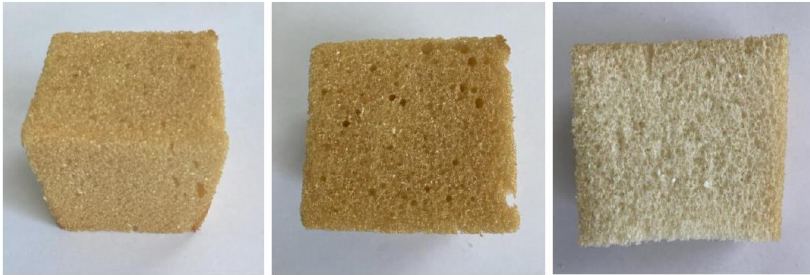
Рис. 2. Зовнішній вигляд зразків ППУ внаслідок впливу ультрафіолету
