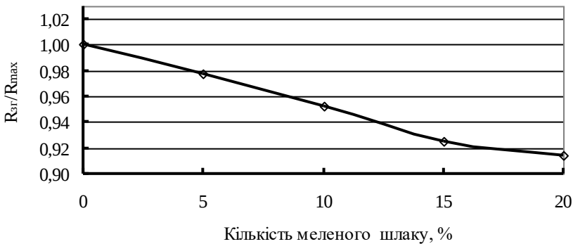
Рис. 4. Залежність зміни міцнісного параметру при згині цементного розчину від кількості заміненого портландцементу меленим доменним шлаком
