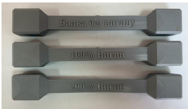
Рис. 3. Експериментальні зразки модельної балки та балок з вигином 100% і 200%
