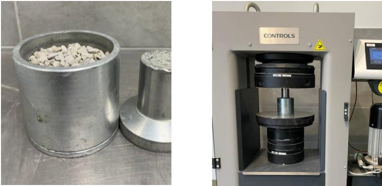
Рис. 7. Процес визначення дробимості крупного заповнювача
