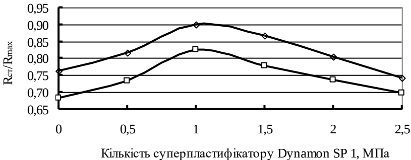
Рис. 5. Залежність зміни міцнісного параметру цементобетону при стиску від кількості введеного суперпластифікатора та кількості портландцементу з додаванням меленого шлаку (ПЦ ІІ/А-ІІІ 500): □ – 375 кг/м³; ◇ – 400 кг/м³
