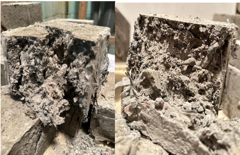
Рис. 3. Руйнування зразків зліва на право Пфб-2 із поліпропіленовою фіброю, Пфб-3 із комбінованою сталевую та поліпропіленовою фіброю
