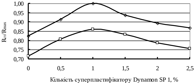
Рис. 1. Залежність зміни міцнісного параметру цементобетону при стиску від кількості введеного суперпластифікатора та кількості портландцементу ПЦ I-500: □ – 375 кг/м³; ◇ – 400 кг/м³
