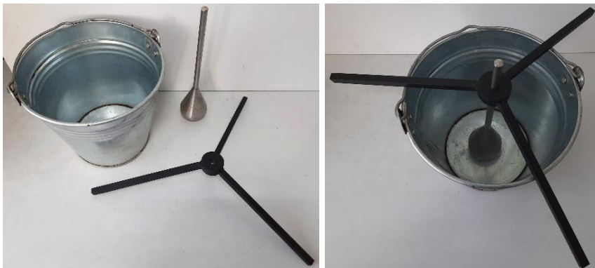
Рис. 1. Зовнішній вигляд обладнання, що застосовувалася для визначення технологічної пластичності литої суміші методом Люєра
