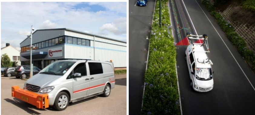
Рис. 3. Сучасні лазерні системи для визначення рівності дорожніх покриттів
