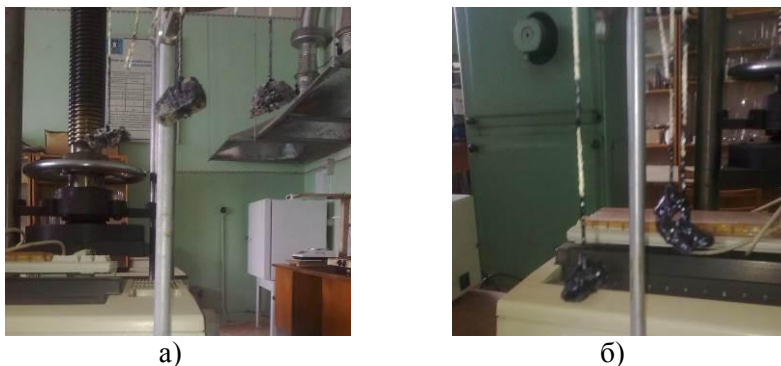
Рис. 1. Зразки зчеплення бітуму з щебенем: а) без добавок; б) з добавкою гумової крихти
