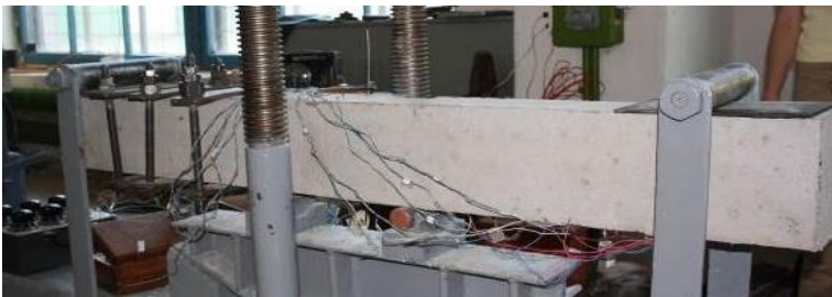
Рисунок 7 – Підсилення ділянок дослідних балок біля опор зовнішніми хомутами
