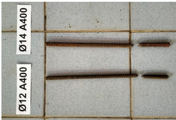
Рисунок 6 – Зруйновані стержні металевої арматури
