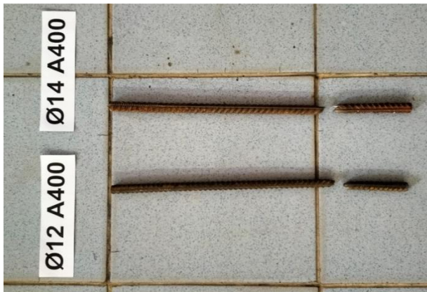
Рисунок 6 – Зруйновані стержні металеві арматури
