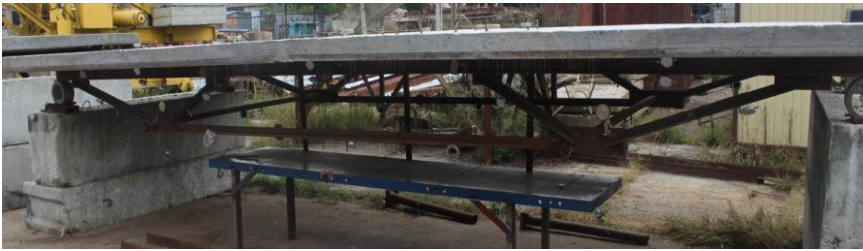
Рис. 2. Просторова сталезалізобетонна комбінована попередньо напружена шпренгельна конструкція
