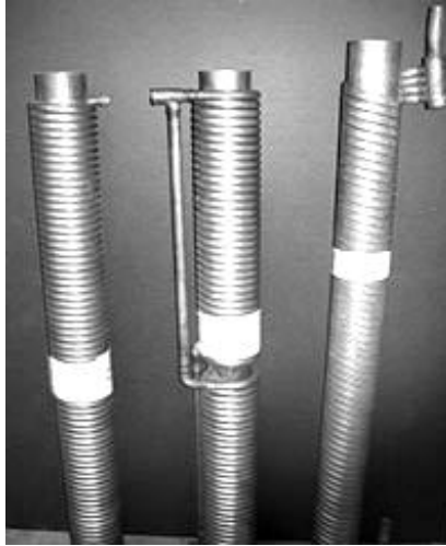
Рис. 1. Зовнішній вигляд компактного теплообмінника для вилучення тепла зі стічних вод
