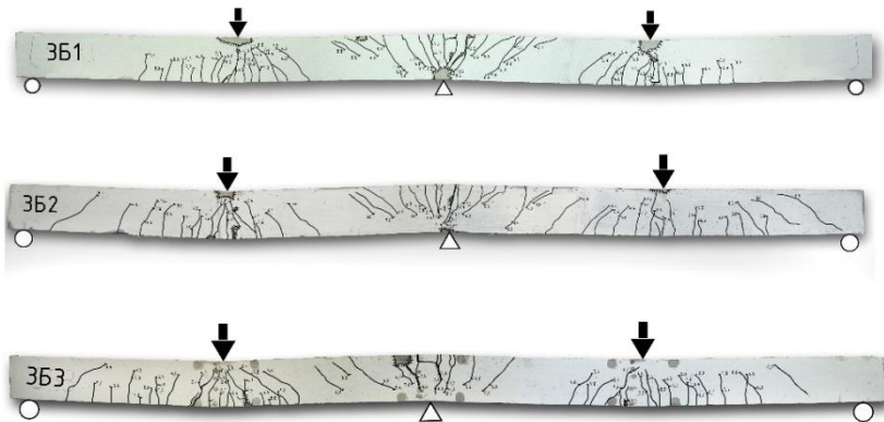
Рис. 6. Характер розвитку тріщин у дослідних балках
