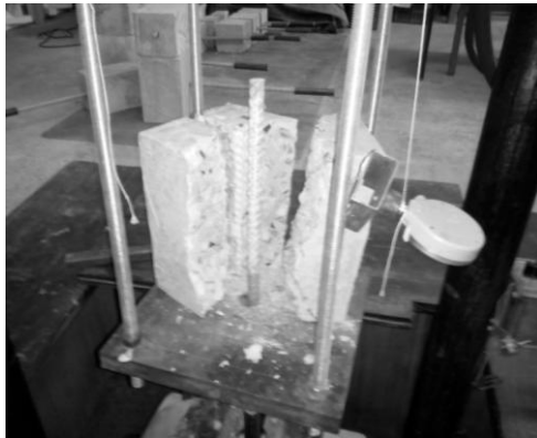
Рис. 3. Розколювання бетонних призм вздовж стержня, довжиною анкерування 240 мм, поперечного перерізу 150 \times 150 мм
