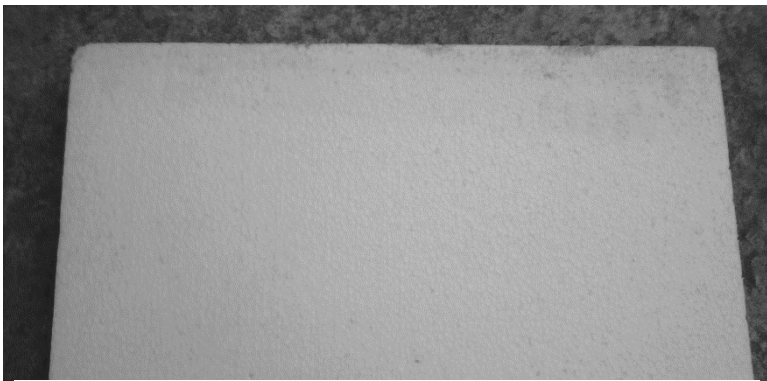
Рис. 3. Пінополістирол, з якого було виготовлено «сендвіч-панель»
