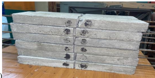
Рис.1. Розтягнутий сталевібробетонний зразок Т-1.2.1 під час випробувань (а) і бетонні та сталевібробетонні зразки Т-1.0 – Т-1.3 після випробувань (б)
