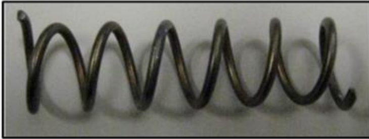
Рис. 2. Пружина із СПФ-дроту [12]
