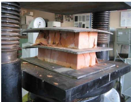
Рис. 3. Схема розміщення дослідних зразків на плиті гідравлічного пресу з використанням резинотканевих пластин
