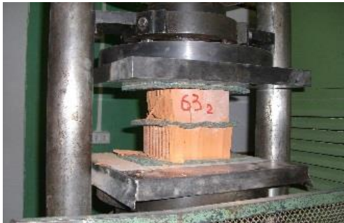
Рис. 2. Схема розміщення зразка на плиті гідравлічного пресу з використанням проміжних пластин технічної повсті
