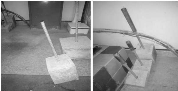
Рис. 3. Захист арматурного стержня від пошкодження в захваті преса
