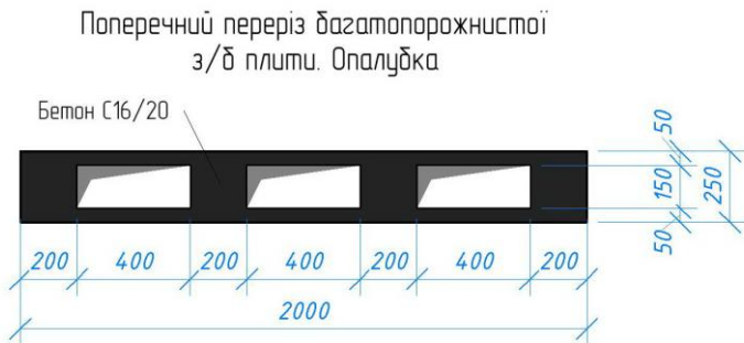
Рис. 10. Поперечний переріз фрагменту перекриття.
