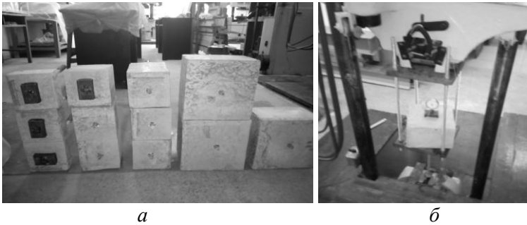
Рис. 2. Дослідні зразки – бетонні призми: а – загальний вигляд бетонних призм першої серії 12шт; б – загальний вигляд випробування бетонних призм
