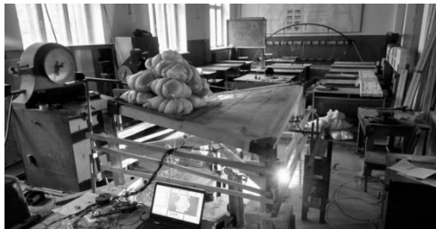
Рис.6. Конструкция оболочки в процессе ее испытания.
