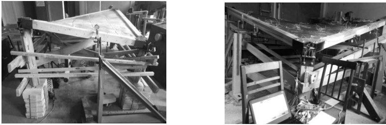
Рис.4. Расположение прогибомеров и индикаторов.
