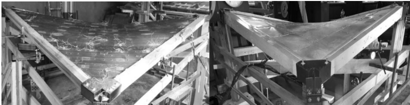
Рис.3. Вид с боку оболочки из параболических панелей размером 3 \times 3 \times 0,035 м (с лево) и из осимгиполических панелей 1,5 \times 1,5 \times 0,04 м (с право) в лаборатории кафедры МДиПК ОГАСА.
