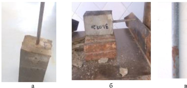
Рис. 3. Зразок з арматурою після витримки у сольовому розчині а – зразок з арматурою, що піддався дії сольового розчину (морська вода) на протязі 65 діб; б – той же зразок на пресі, для видалення з нього арматури; в – арматура, що видалена із зразка після витримки у сольовому розчині після 65 діб
