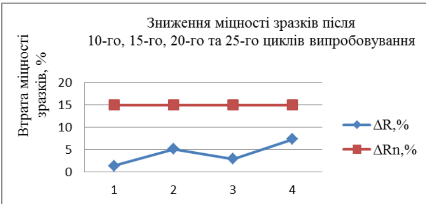
Рис. 4. Зниження міцності зразків після 10-го (1), 15-го(2), 20-го (3) та 25-го (4) циклів випробування необроблених зразків
