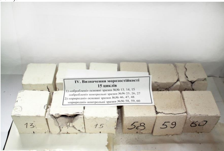
Рис. 2. Зразки після 15-го циклу випробування на міцність
