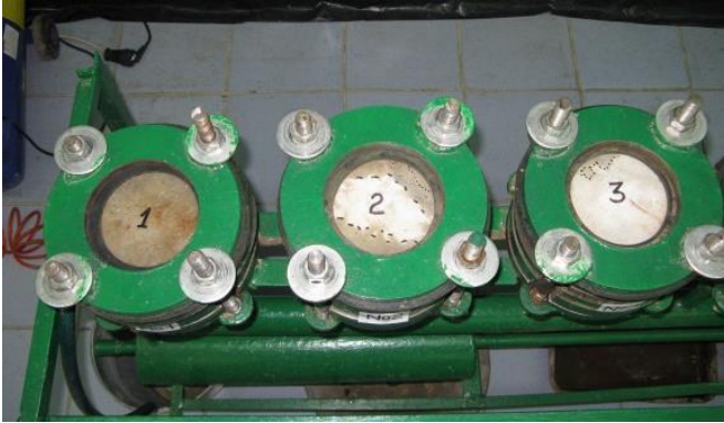
Рис. 1. Дослідження зразків бетону на водонепроникність методом «микрої плями»
