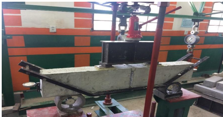
Рис 2. Балка під час випробувань
