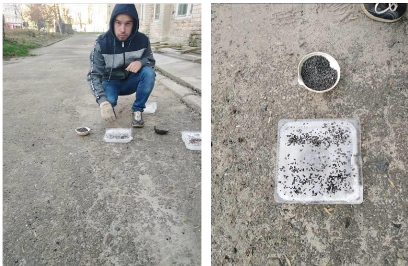
Рис. 3 Посипання імітованого обледенілого дорожнього одягу гарячим гранітним і базальтовим відсівом
