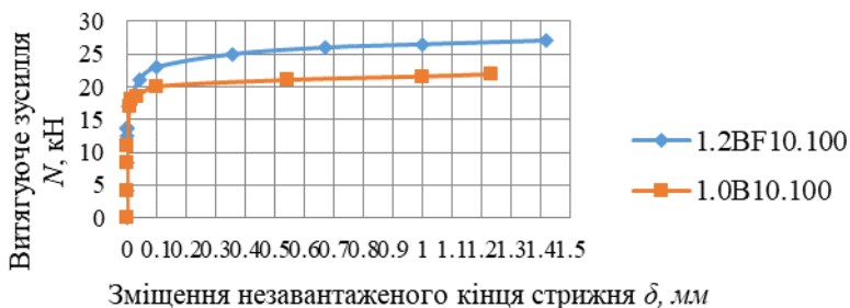
Рис.3. Залежність зміщення незавантаженого кінця стрижня від витягуючого зусилля для балок 1.2BF10.100 і 1.2BF10.100
