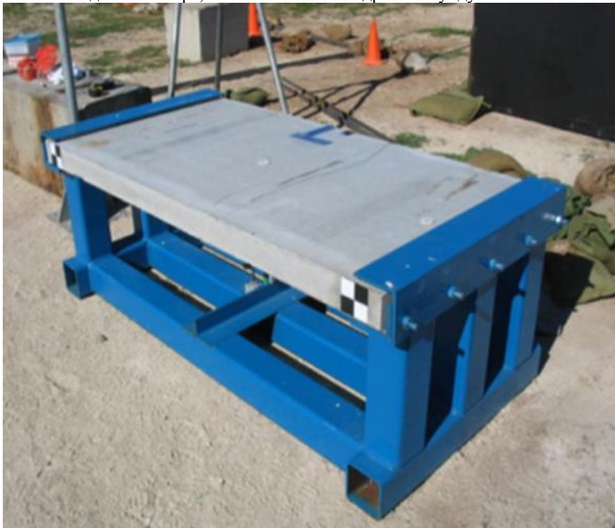
Рис. 1. Сталева рама для закріплення моделей залізобетонних плит
