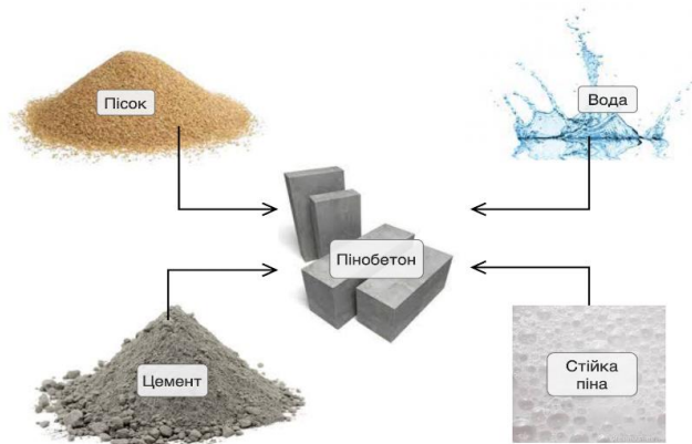
Рис. 2. Матеріали для пінобетону
