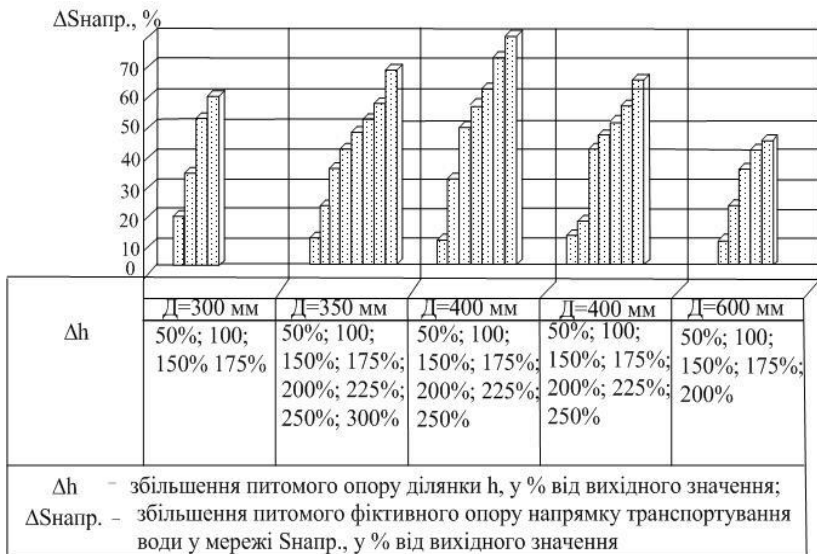
Рис. 2. Діаграми залежності питомого фіктивного опору напрямку транспортування води у мережі від питомого опору ділянки
