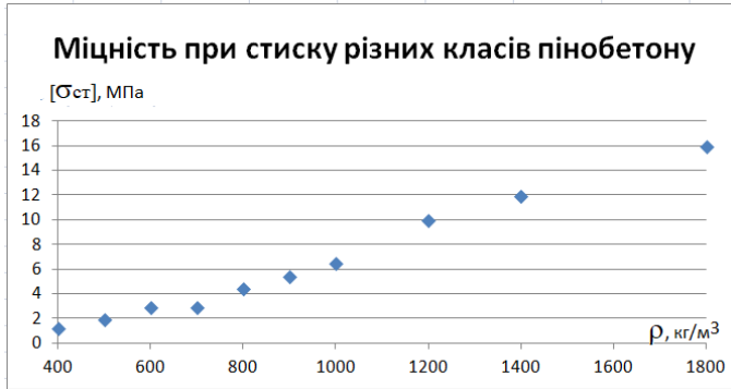
Рис. 3. Міцність пінобетону при стиску
