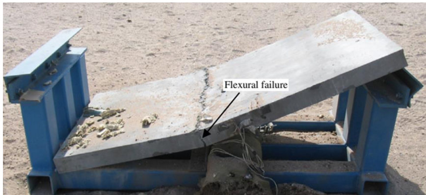
Рис. 6. Руїнування фібробетонної армованої плити RUHPFC
