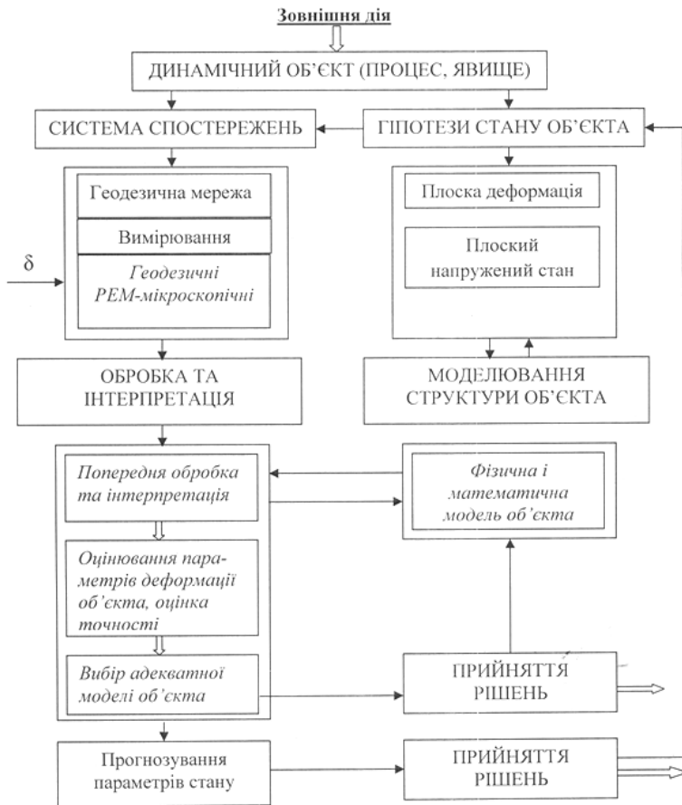
Рис. 1. Функціональна схема розв'язку задач ідентифікації деформацій складних динамічних об'єктів
