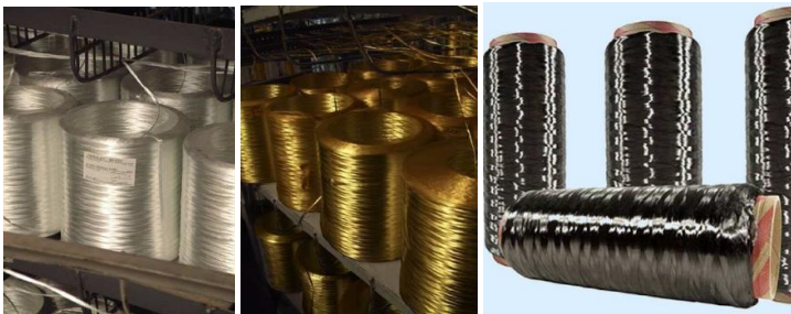
а) скловолокно б) вуглеволокно в) базальтоволокно Рис.1. Види волокон для виготовлення композитної арматури
