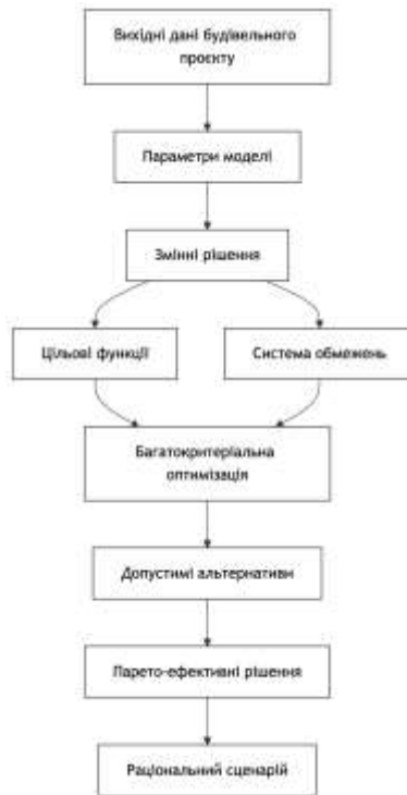
Рис. 1. Загальна схема формування багатокритеріальної математичної моделі оптимізації організаційно-логістичних процесів у цивільному будівництві
