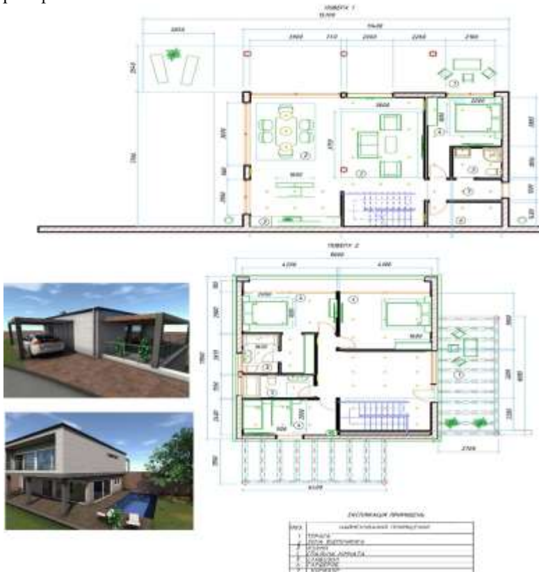
Рис. 3. Планувальні рішення поверхів будинку після реконструкції
