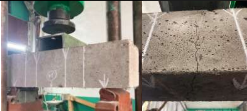
Рис. 2. Випробування призми із фібробетону на розтяг при згині
