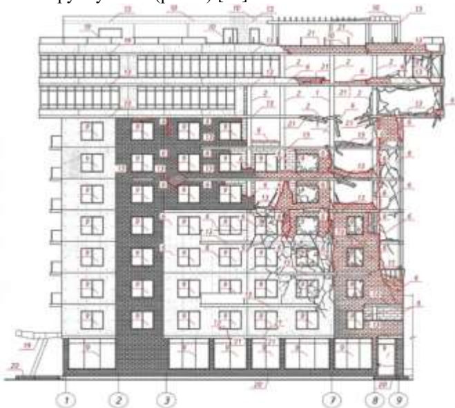
Рис. 2. Схема просторового розташування пошкоджень і зон деформацій на фасаді будівлі
