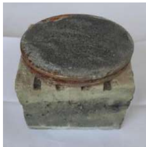
Рис. 3. Зразок куба із торкретбетonom на фрезерованій поверхні
