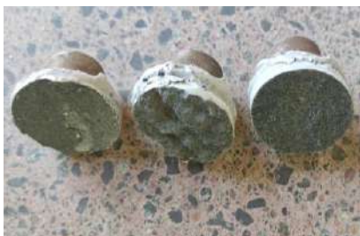
Рис. 6. Дослідні зразки із шарів торкрет бетону перекриття
