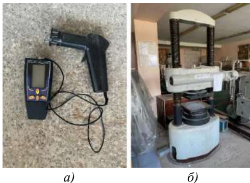
Рис. 1. Лабораторне обладнання для вимірювання міцності: а - електронний склерометр (неруйнівний метод); б - прес ПСУ-250 (руйнівний метод)
