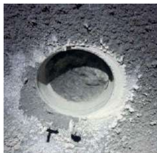
Рис. 5. Шурф після відривання від масиву поверхні
