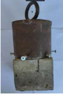
Рис. 8. Зразок шорсткої поверхні торкретбетону в обоймі
