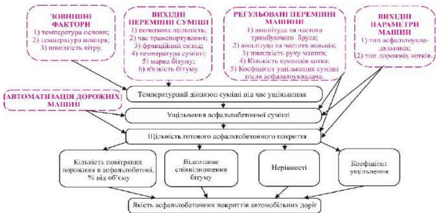
Рис.1. Інформаційно-функціональна схема виробничо-технологічних факторів процесу ущільнення, що впливають на якість асфальтобетонних покриттів
