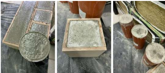
Рис. 3. Процес виготовлення експериментальних зразків – циліндрів і кубів
