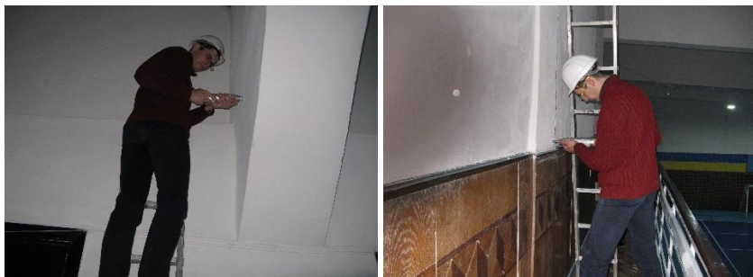
Рис. 2. Визначення фізико-механічних характеристик бетону неруйнівним методом (склерометром Шмідта АТ241/Е клас N, виробництва «Technotest» S.a.s, Італія)
