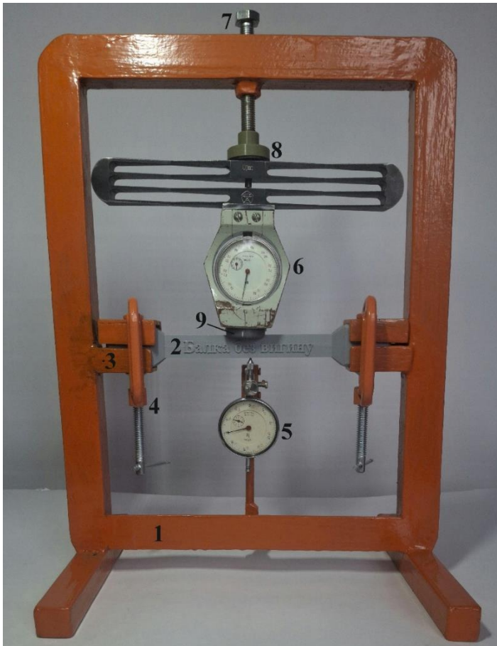
Рис. 4. Установка для дослідження балок з будівельним вигином
