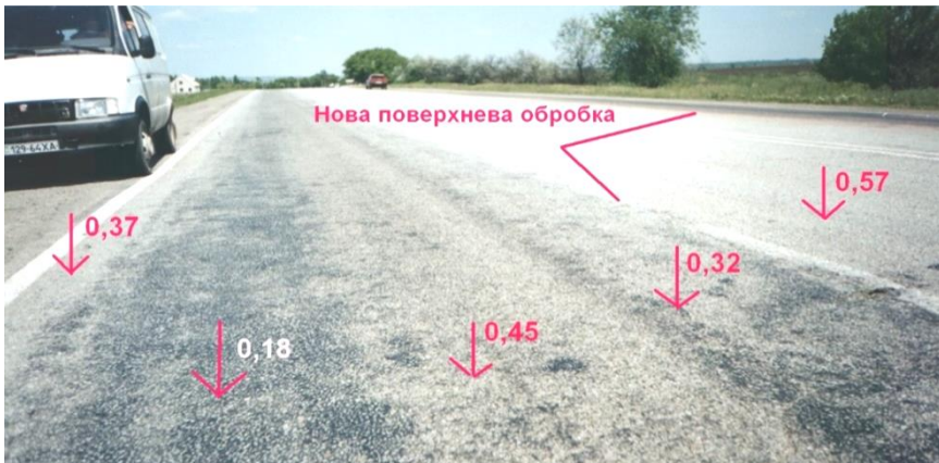
Рис. 2. Результати вимірювання коефіцієнта зчеплення на автомобільній дорозі I категорії в Донецькій області
