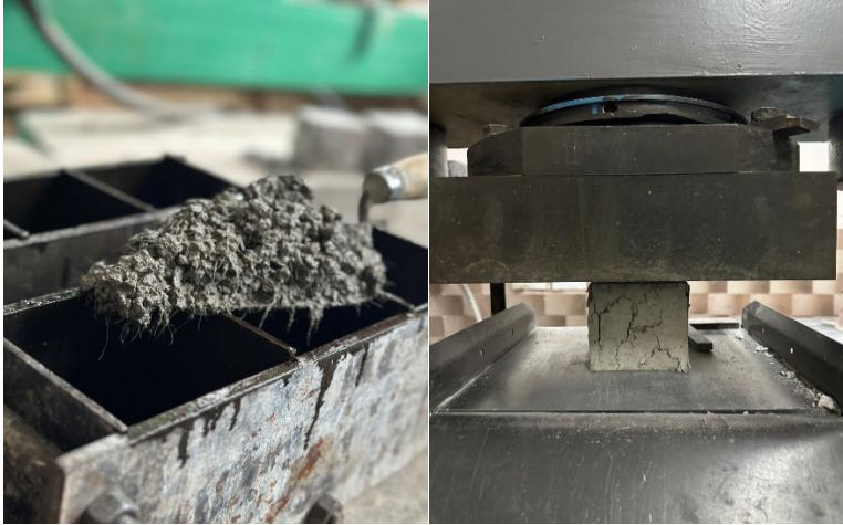
Рис. 2. Формування та випробування зразків із фібробетону
