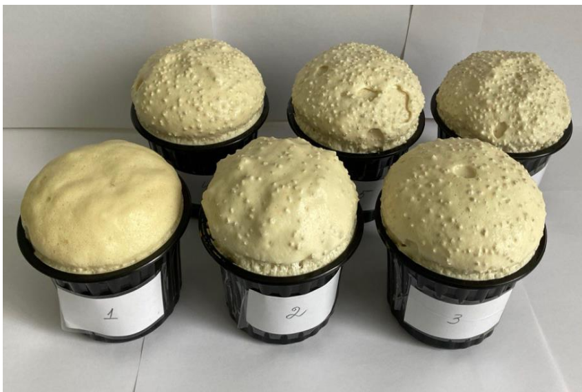
Рис. 2. Зовнішній вигляд серії композицій ППУ, модифікованих слученим перлітом
