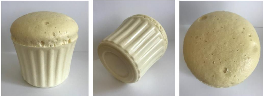
Рис. 1. Зовнішній вигляд модифікованої силіконом композиції ППУ
