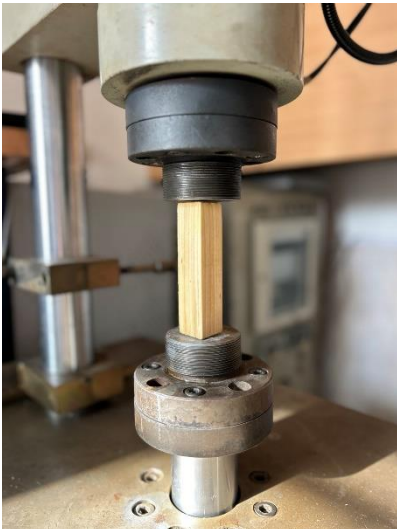
Рис. 3. Модифікована деревина ялини після занурення у воді
