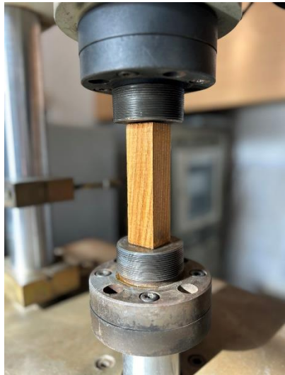
Рис. 4. Модифікована деревина ясена після занурення у воді
