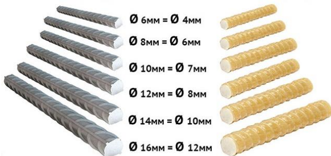
Рисунок 5 – Умовна заміна металеві арматури на склокомпозитну по фізико-механічних властивостях виробників
